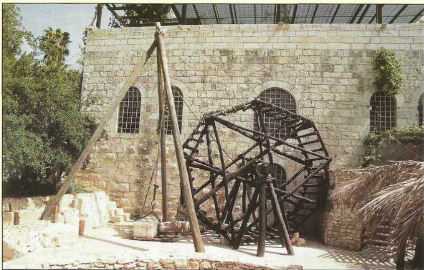
fig. #105 Réplica de um guindaste romano, com roda e tripé, levantando a pedra. Esta réplica está baseada em relevos decorativos romanos como na fig. no. 107.
